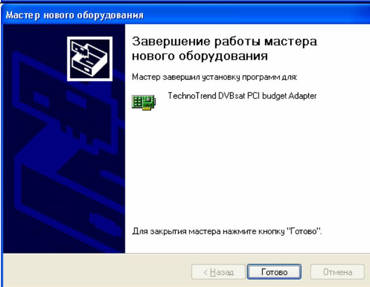
8. Если мы откроем «Диспетчер устройств», то в разделе «Сетевые платы» сможем обнаружить новое устройство «TechnoTrend DVBSat PCI budget Adapter».
