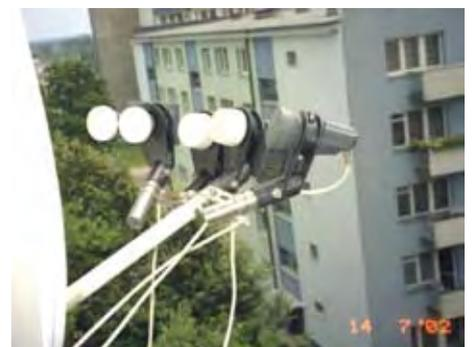
MultiConnect является инновационной системой, которая была разработана для обеспечения организации новых или существующих сценариев приема сигнала с нескольких спутников используя стандартную спутниковую антенну. Данная система позволяет легко преобразовать существующую систему с одним LNB в систему "multi feed" без приобретения новой антенны. В случае новой установки, система MultiConnect позволяет приобретать стандартную спутниковую антенну вместо более дорогих.
